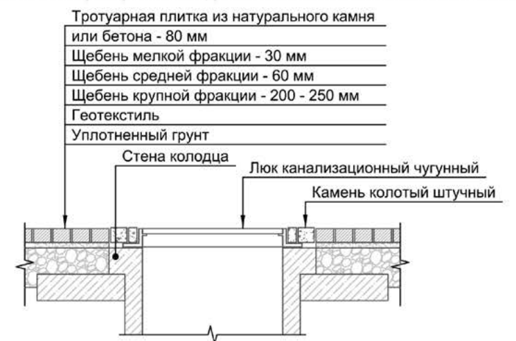
Принципиальная схема установки круглого канализационного люка в мощение (план)
